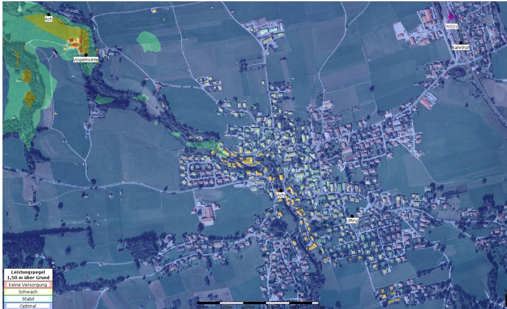
Abbildung 15: Detail zu Abb. 1 auf Seite 7 (GSM-900). Berechneter Versorgungspegel zum bestehenden Funkturm in Seehausen (B02) und dem gewünschten Standort auf dem Bahnhofsdach (W02): Ortsteil Uffing mit schwacher bzw. nicht sicher gestellter Indoor-Versorgung im Achtal (gelb markierte Gebäude). Z.T. besiedelte Bereiche (Vogelmühle) mit unwahrscheinlicher Indoor-Versorgung (rot markierte Gebäude).
