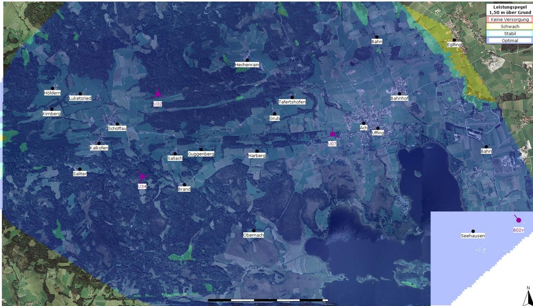
Abbildung 9, Beispielszenarium B: Berechneter Versorgungspegel zu ausgewählten zur Ausweisung beabsichtigten Konzentrationszonen (B02, U07, U32, U34 / GSM-900). Im Gemeindegebiet optimale bis stabile Versorgung.
