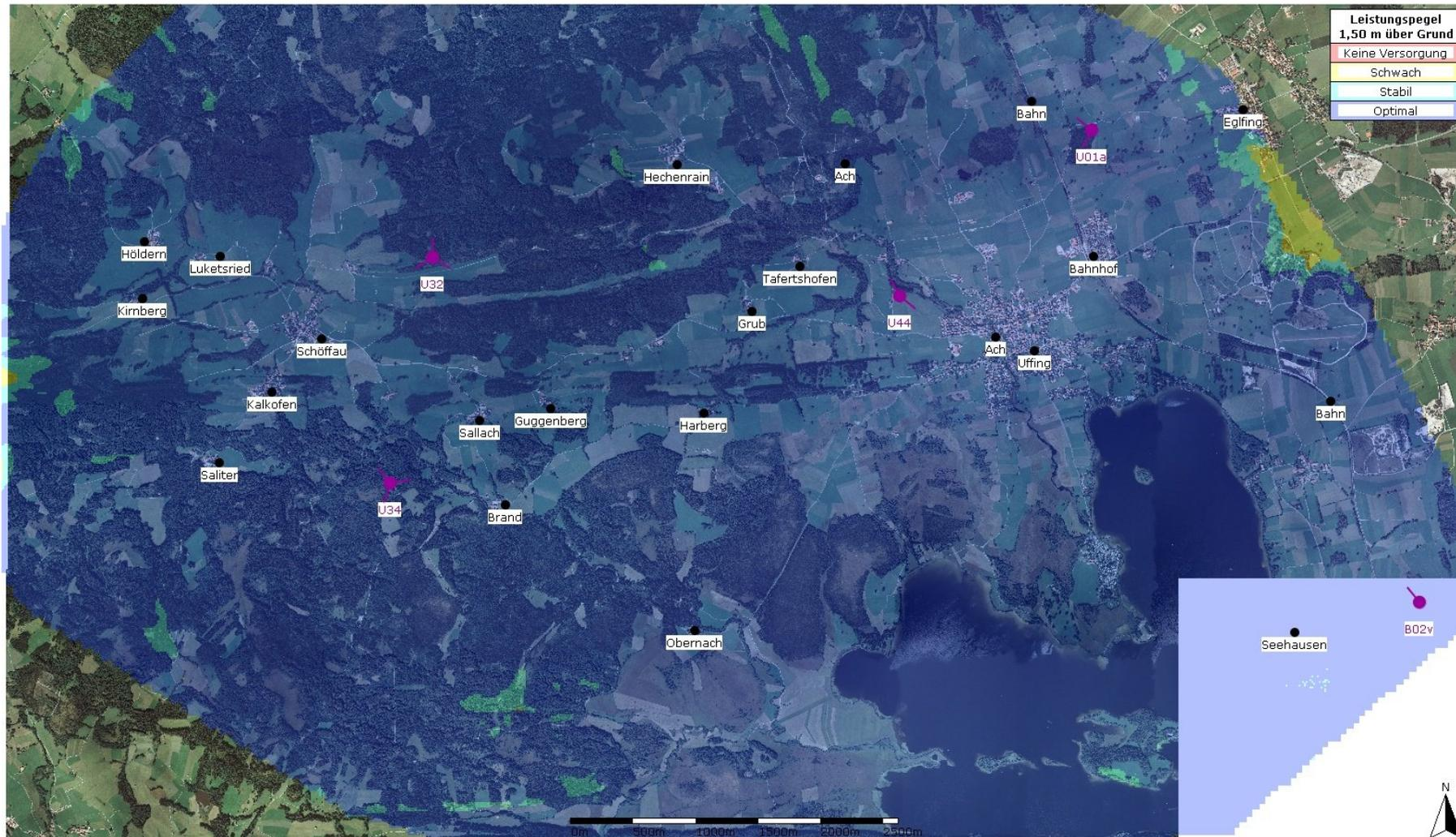
Abbildung 11: Beispielszenarium C: Berechneter Versorgungspegel zu ausgewählten zur Ausweisung beabsichtigten Konzentrationszonen (B02, U01a, U32, U34, U44 / GSM-900). Im Gemeindegebiet optimale bis stabile Versorgung.
